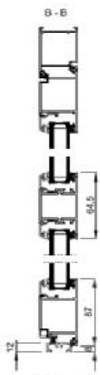
Obr. 2. Řez svislý hliníkovými dveřmi bez přerušeného tepelného mostu, s prahem, systém MB45.
