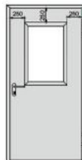
Rys. 12. Sposób doboru przeszklienia.
