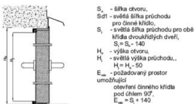
Obr. 17. Montáž před otvorem - svislý řez.
